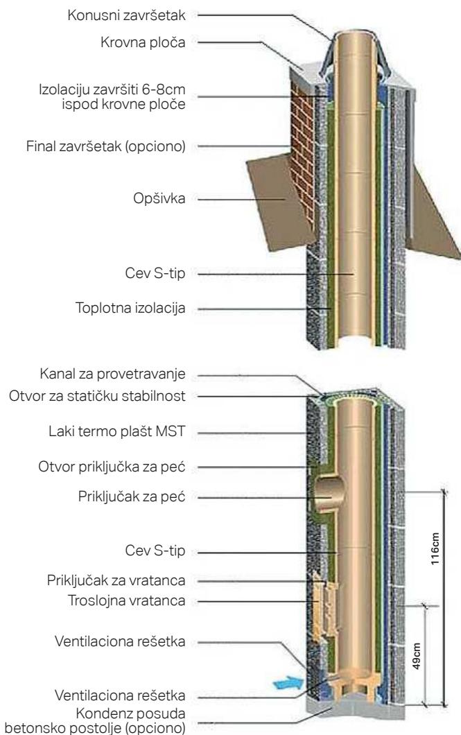
Setovi su pakovanja kompletног dimnjačkog sistema na jednoj paleti i izrađuju se u standardnim visinama:
